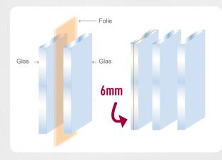
SecuWin bietet als Standardfenster (1230 x 1480 mm) einen Wärmedurchgangskoeffizienten von U<sub>w</sub> 1,0 - 0,76 (Dreifachverglasung) und einen erhöhten Einbruchsschutz durch Verbundsicherheitsglas\* 6mm.
